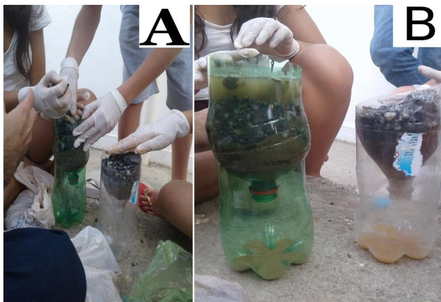
FIGURA 3 - Filtros elaborados com garrafa pet, algodão, terra, areia e britas
