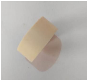
Figura 10 – Anel feito com o cano de PVC
