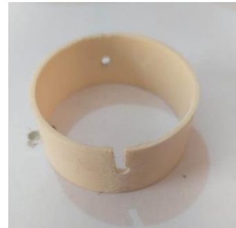
Figura 11 – O anel deve ter dois encaixes para o eixo
