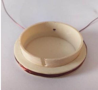
Figura 18 – Suporte e eixo da bobina
