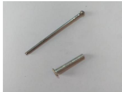
Figura 7 – Rebite ref-312 sem a parte de alumínio
