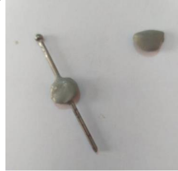
Figura 9 – Massa epóxi cobrindo ímã
