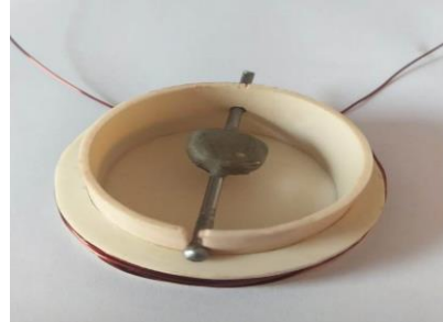
Figura 19 – Suporte e eixo da bobina
