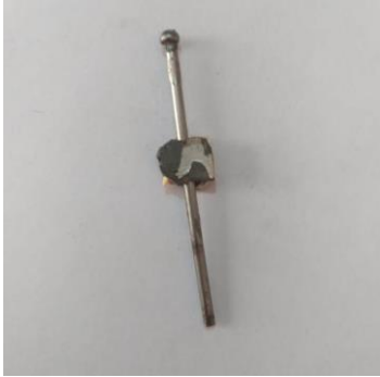
Figura 8 – Ímã localizado no centro do rebite
