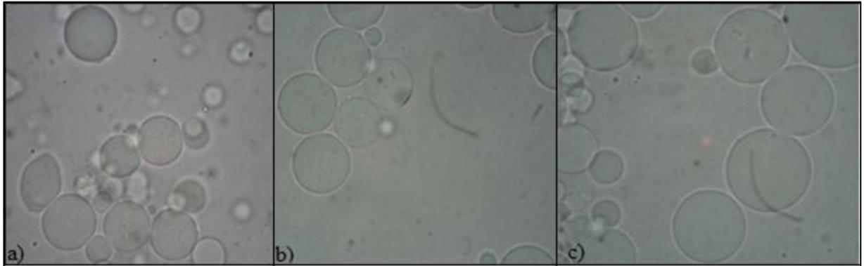
**Figura 6:** Microscopia óptica das micropartículas de xilana com diferentes concentrações de STMP: (a) F9 (100mg); (b) F1(200mg) e (c) F2 (400mg) em aumento de 100X.
