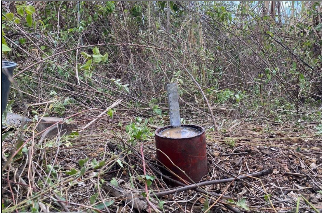
Figura 4. Infiltrômetro com água e regra graduada durante a realização do experimento.
