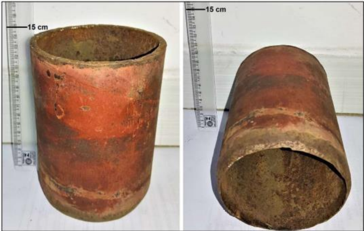
Figura 3. Infiltrômetro utilizado na realização dos experimentos da pesquisa.
