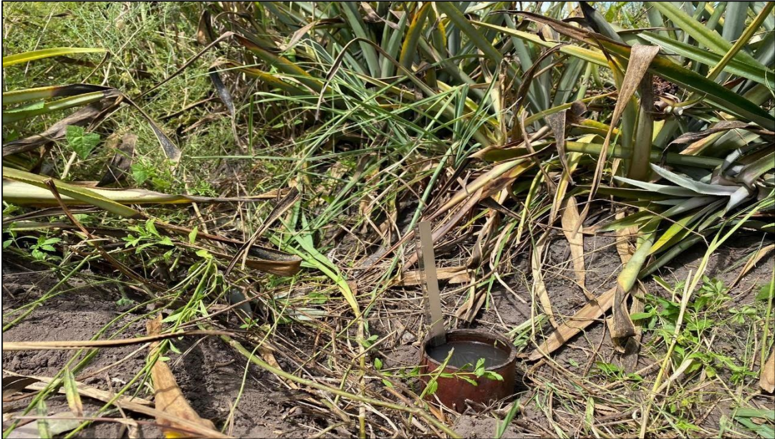
Figura 7. Experimento com infiltrômetro em área de Abacaxi.
