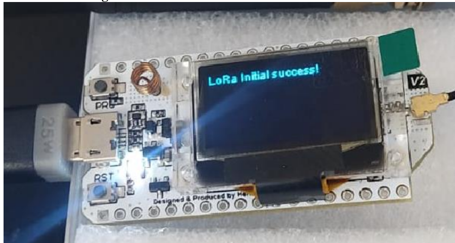
Figura 13 - ESP32 recebendo os dados dos sensores
