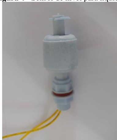
Figura 4 - Sensor de nível para líquidos
