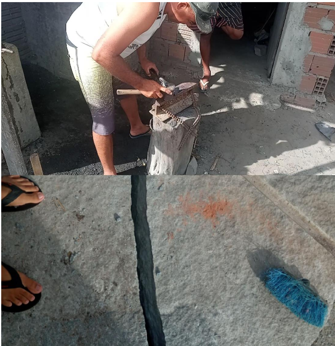
Figura 3 – Trabalhador afiando ferramenta conhecida como “carvão” e abaixo bloco de granito em processo de separação.
