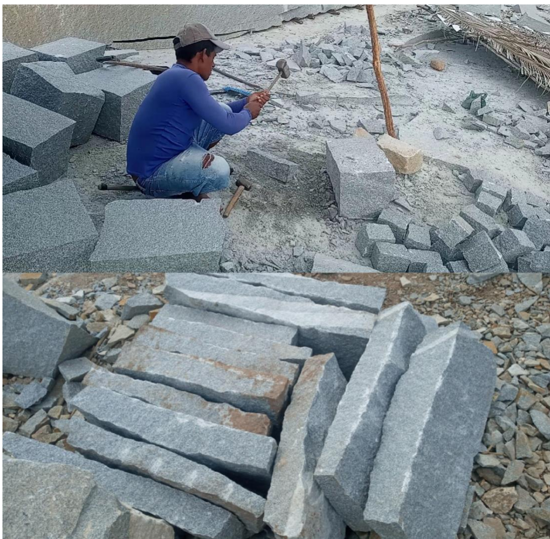
Figura 4 – Trabalhador fragmentado a rocha em partes menores e abaixo um dos resultados do seu trabalho “meio fio”
