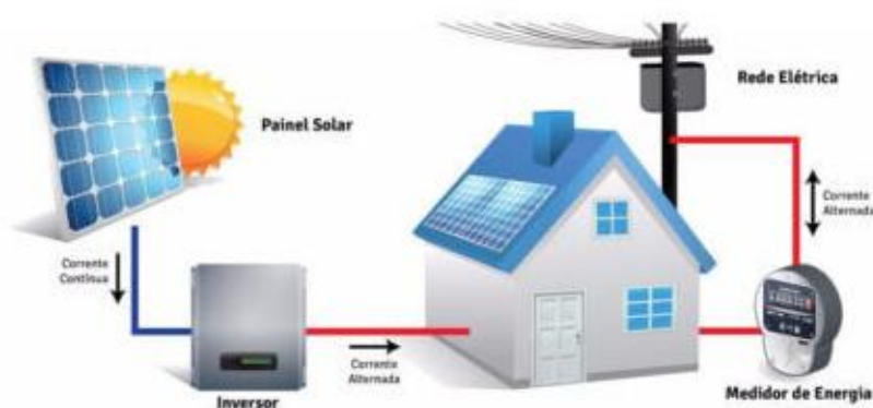
Figura 2 - Sistema de Geração Fotovoltaico On Grid.
