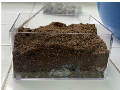
Figura 8 – Preenchimento do solo por cima da camada drenante
