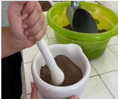
Figura 7 – Destorroamento de solo
