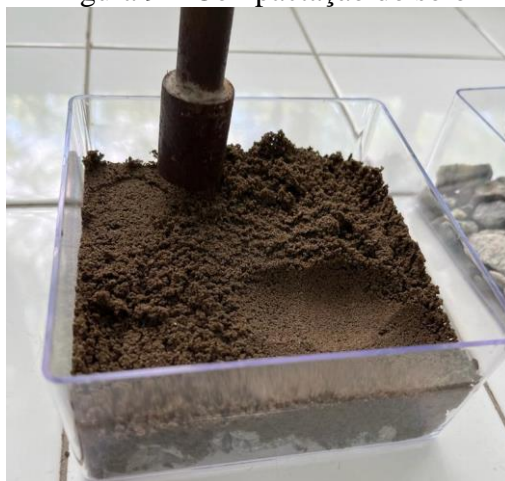
Figura 9 – Compactação do solo
