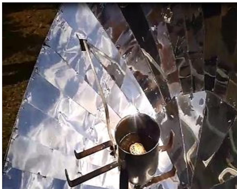
Figura 5 - Cozimento de café utilizando o fogão solar.
