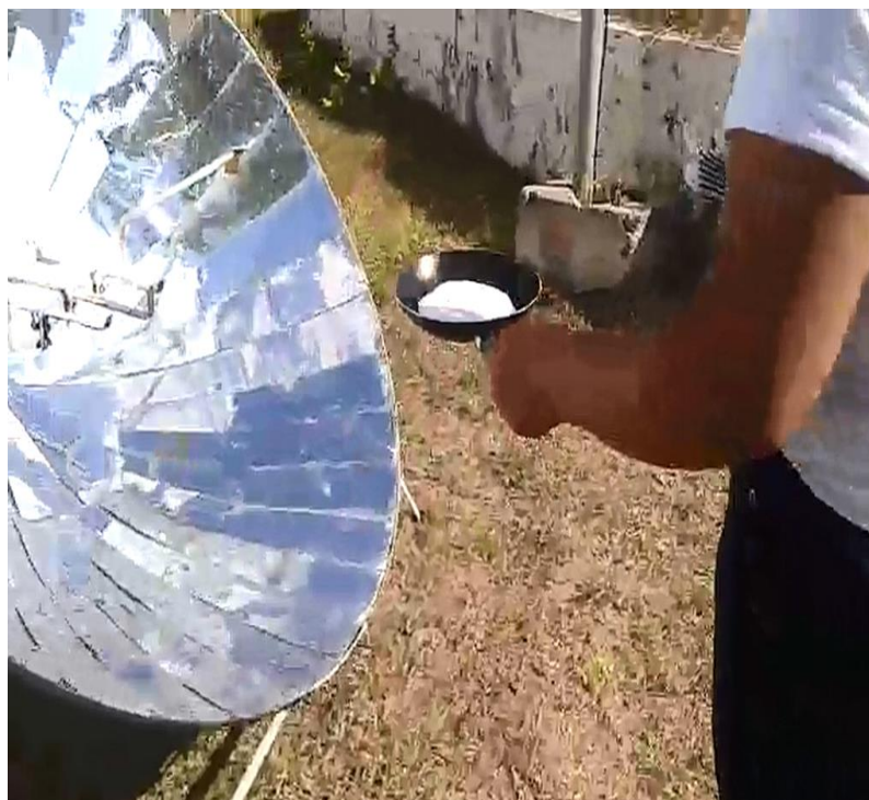
Figura 4 – Cozimento de tapioca utilizando o fogão solar.
