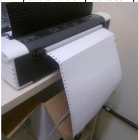
Imagem 4 - Fotografia de impressora Braille em processo de impressão com papel 40 Kg
