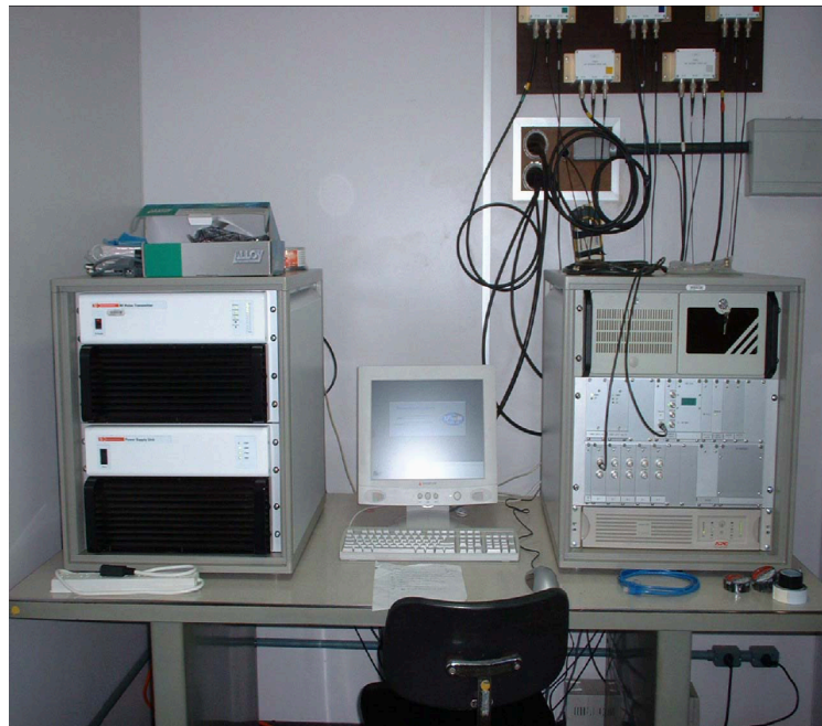
Figura 6 - Hardware com receptores, transmissor e o computador que processa e armazena os dados coletados.
