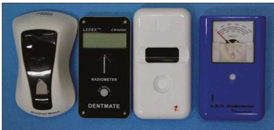
Figura 9: radiometro utilizado para aferir a irradiância de luz das UF tipo LED. Os 3 modelos a esquerda apresentam diplay digital, e um modelo a direita possui display analógico.
