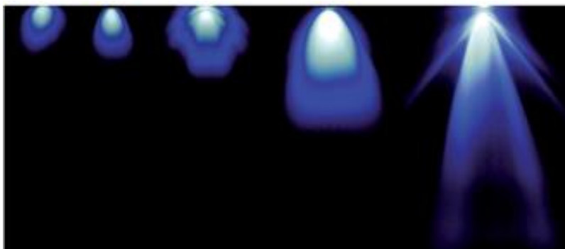
Figura 12: colimação de luz de diferentes gerações de LED. Quanto maior a distância da extremidade da ponteira óptica menor é a irradiância. As duas imagens a esquerda correspondem a colimação de luz dos aparelhos de primeira geração. A terceira imagem a esquerda corresponde a LED de segunda geração. As duas imagens a direita representam a os aparelhos de terceira geração.
