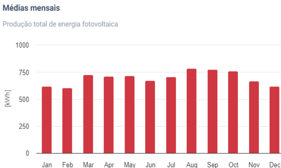
Gráfico 1: Projeção de geração de energia.
