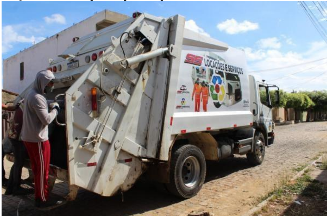
Figura 2: Veículo tipos compactador para recolhimentos dos resíduos sólidos.
