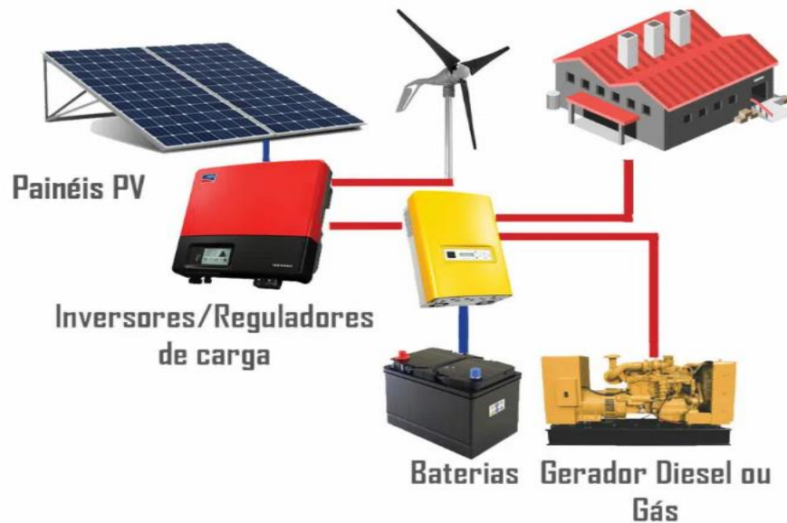
Figura 7 - Sistemas fotovoltaico / eólico híbrido e componentes
