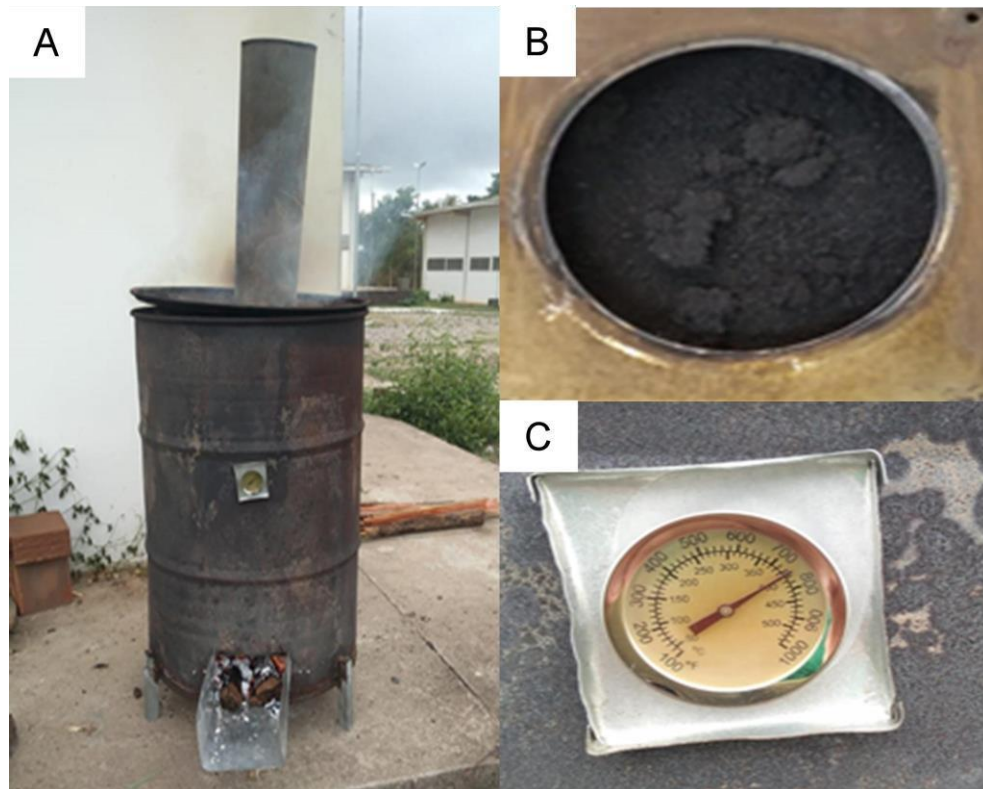
Figura 1. Forno do tipo “tambor duplo” (A), recipiente de 20L (B) e termômetro (C). Fonte: FERNANDES & SILVA, 2021.
