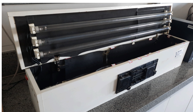
Figura 5: Fotorreator utilizado durante os testes fotocatalíticos
