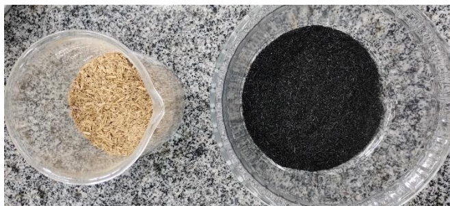
Figura 5 – Casca de arroz antes e após a pré queima
