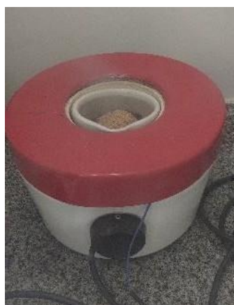
Figura 4 – Manta aquecedora no momento da pré queima
