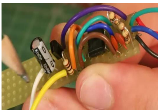
Figura 41: Inserindo os jumpers
