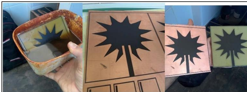
Figura 22 - Momentos do processo de adesivação e da corrosão
