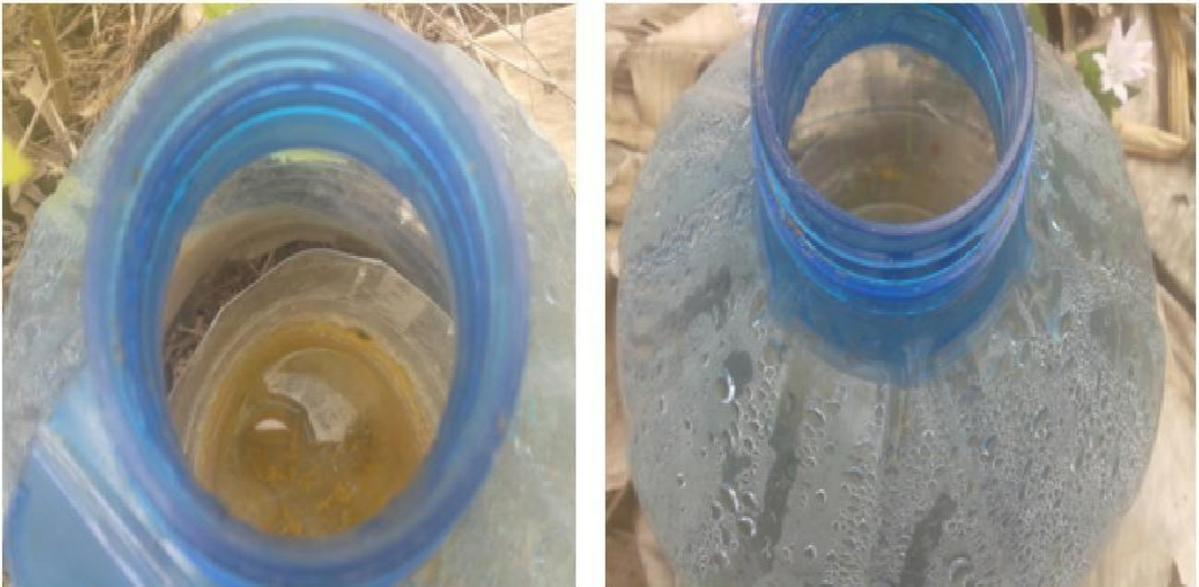
Figura 3. A água evapora e condensa na parte interna da garrafa maior.
