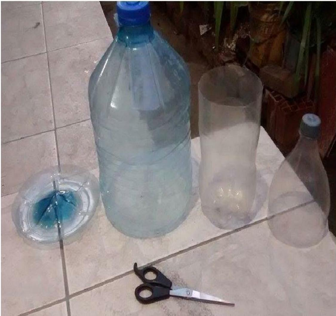
Figura 2. Recorte das garrafas para fabricação dos Dessalinizadores
