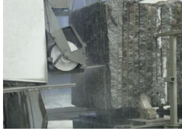
FIGURA 3- Tear de multifio para desdobramento de rochas ornamentais
