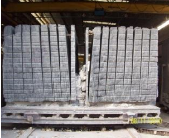
FIGURA 2- Chapas de granito no carro porta-bloco após desdobramento no tear convencional
