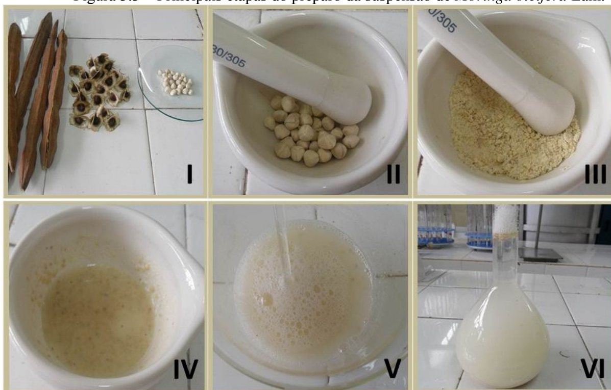
Figura 3.3 – Principais etapas do preparo da suspensão de Moringa oleifera Lam.
