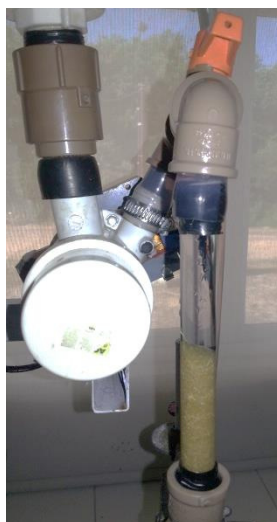
Figura 15: Empacotamento da biomassa na coluna de leito fixo
