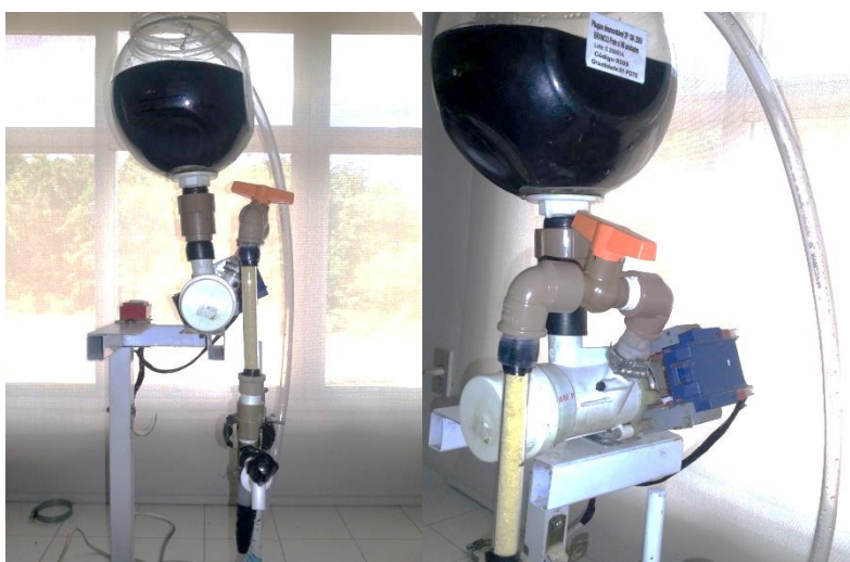
Figura 14 - Sistema de adsorção em coluna de leito fixo
