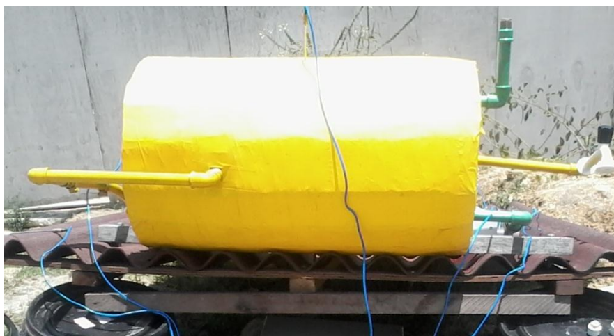
Figura 10: Reservatório térmico construído com materiais alternativos.
