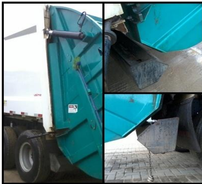
Figura 6 – Sistema de vedação da porta traseira e depósito de armazenamento de chorume.
