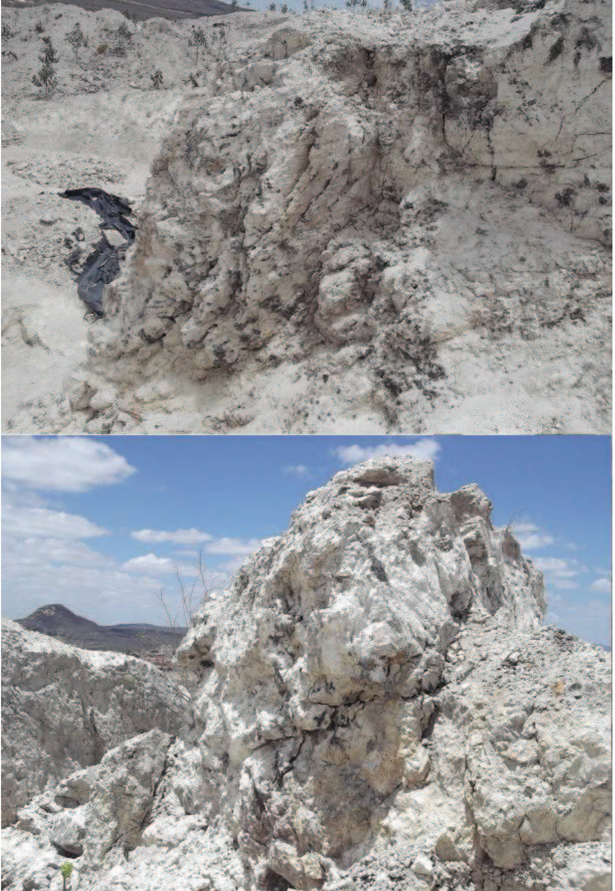
Figura 10: Blocos rochosos instáveis e com fraturas descontínuas
