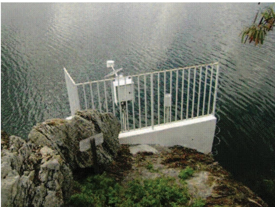
**Figura 7.** Plataforma Coletora de Dados (PCD), instalada as margens do açude Epitácio Pessoa, Boqueirão, PB.
