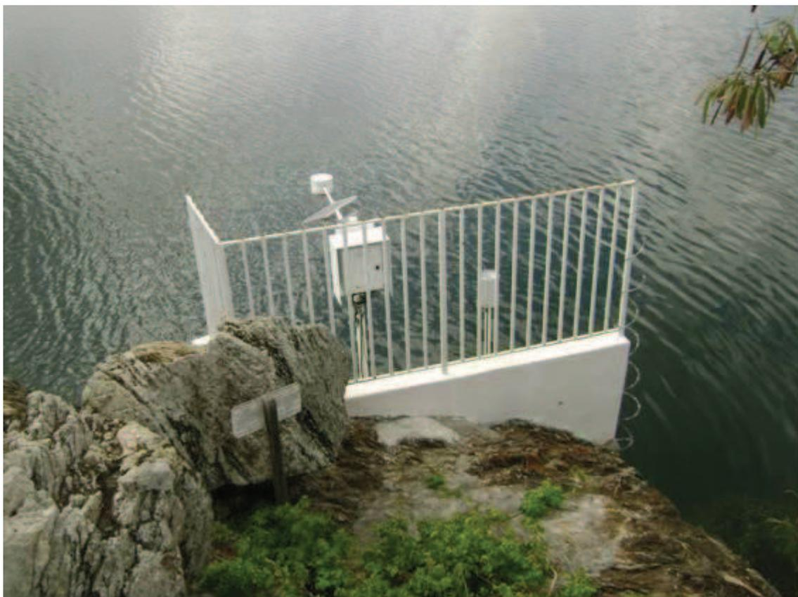
**Figura 27.** Plataforma Coletora de Dados (PCD)
