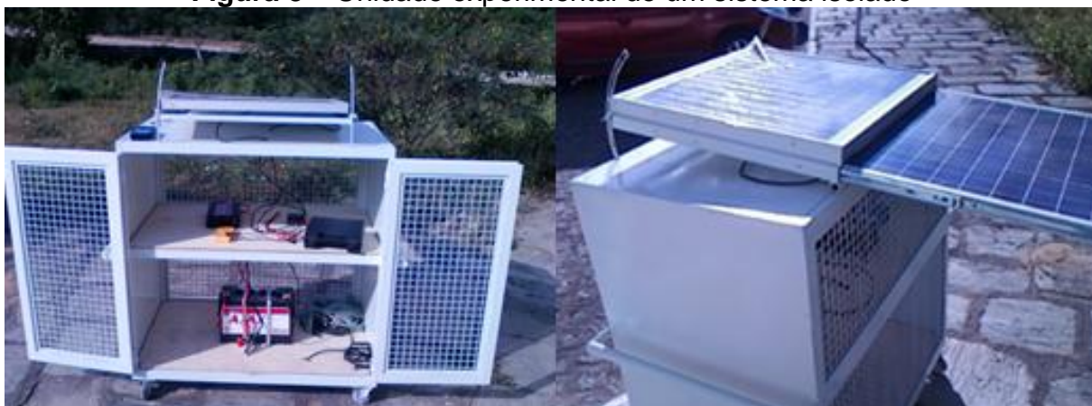
Figura 8 – Unidade experimental de um sistema isolado
