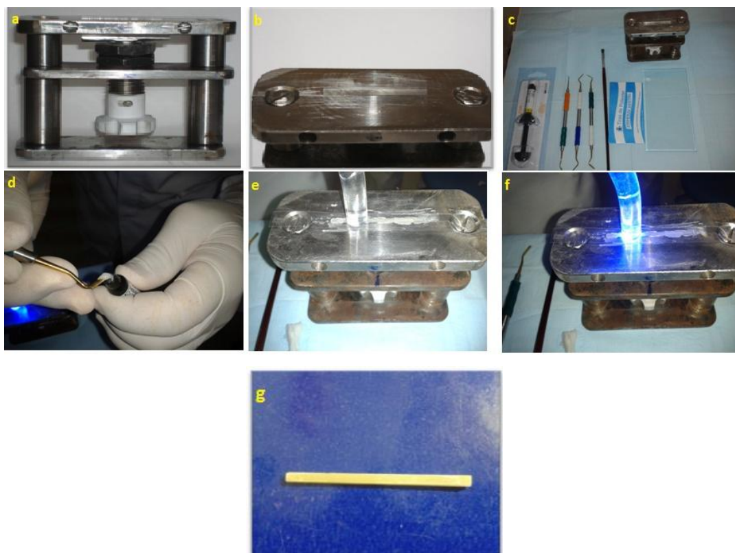
Figura 6 – a-c: Matriz metálica usada para obter as amostras para o teste de flexão três pontos; d-f: cavidade da matriz preenchida para preparação dos corpos de prova e posterior polimerização; g: corpo de prova para ensaio de flexão.
