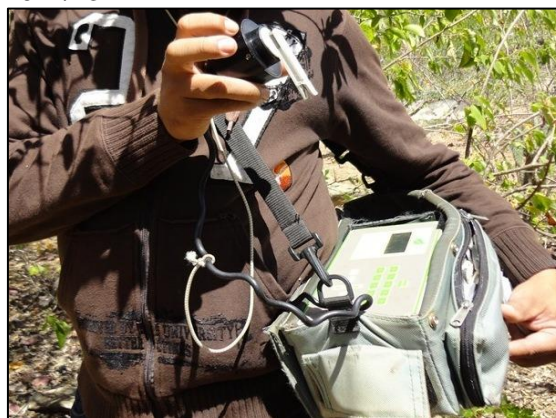
Figura 3 - Detector de fluorescência do tipo PEA (Plant Efficiency Analyser), marca Hansatec, usado em campo. Soledade – PB, 2012/13.
