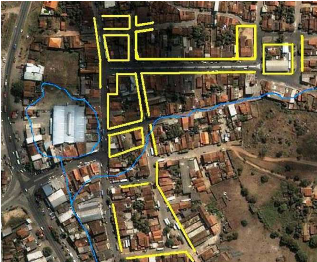
Figura 6: Reconstituição da antiga rede de drenagem, contorno do antigo açude, traçado dos quarteirões.
