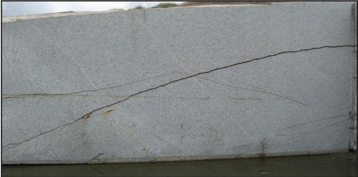
**Figura 14 – Corte para retirada de granito do lajedo.**
