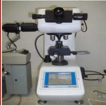
**Figura 2.8.2** Microdurômetro.
