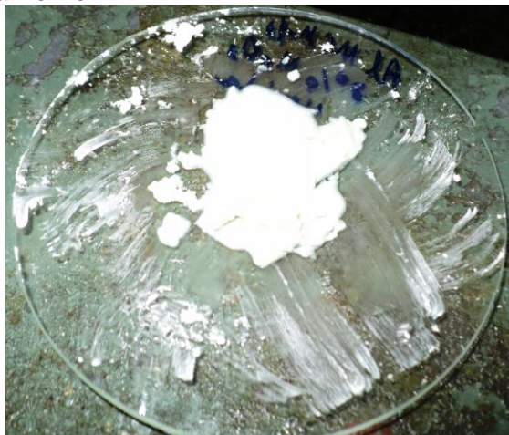
Figura 13: Impregnação via úmida do suporte Al-MCM-41 com o sal heptamolibdato de amônio.
