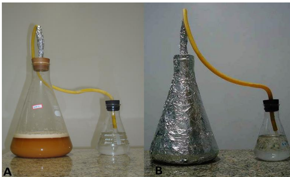
Figura 3. Biorreator: (A) Biorreator contendo o mosto e o inóculo; (B) Biorreator contendo o mosto e o inóculo envolto em papel alumínio. Foto: P. C. Oliveira Neto. Campina Grande, 2013.
