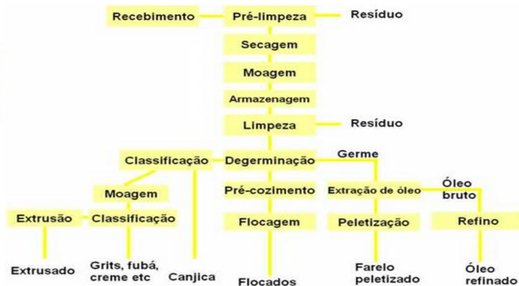
FIGURA 12: Fluxograma industrial de moagem de milho a seco.
