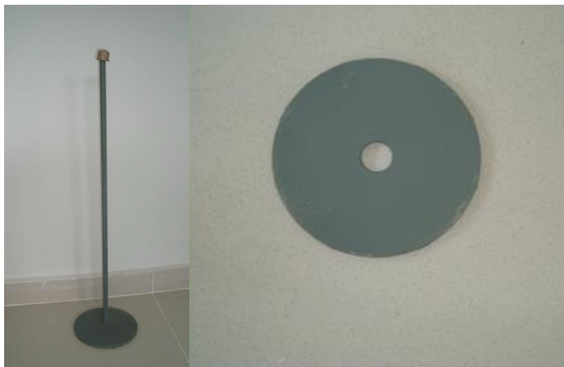
Figura 11 - Medidores de recalques superficiais e em profundidade.
