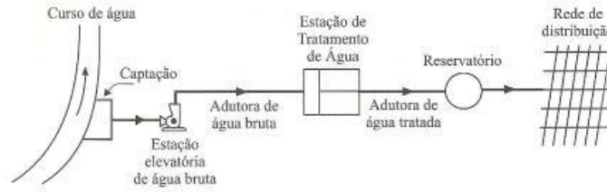
Figura 1: Esquema de um sistema simples de abastecimento de água.
