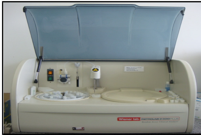
Figura 6: Espectrofotômetro Metrolab 2300 Plus usado na leitura da absorbância. Brasil, 2014.
