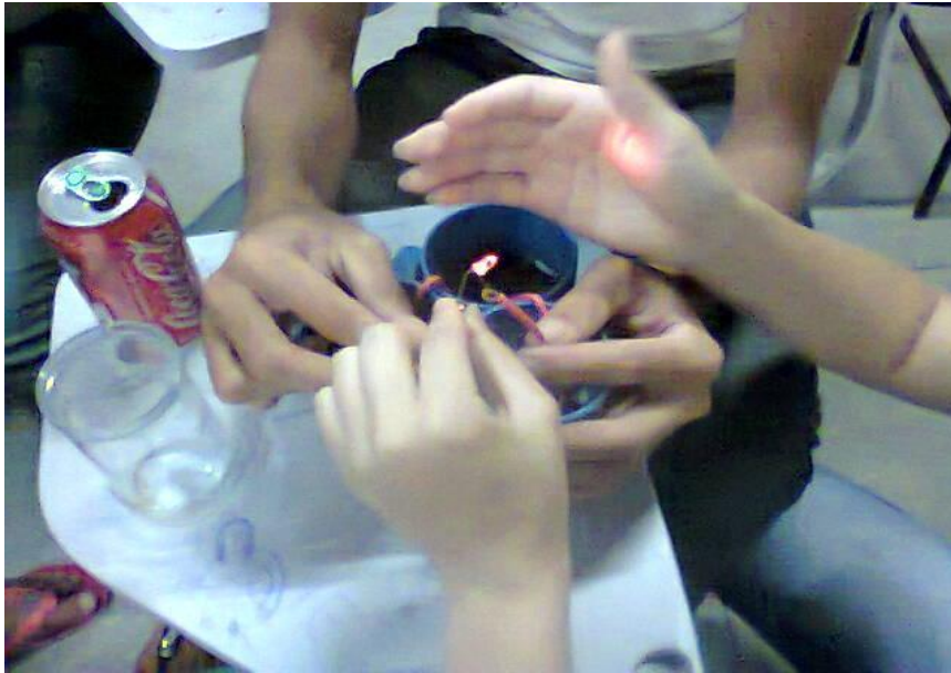
Pilha de coca-cola, fazendo acender um led
