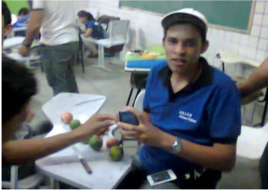
Aluno Manoel Robsom ligando uma calculadora utilizando uma pilha de limões
