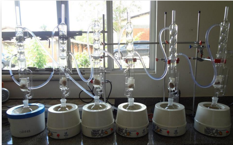
Figura 8 - Sistema de extração em Soxhlet.
