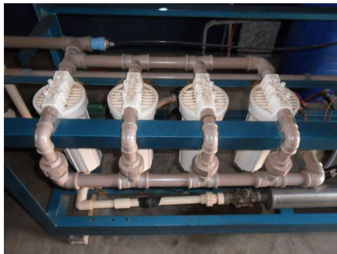
Figura 3.5 - Filtros para remoção de sal na água
