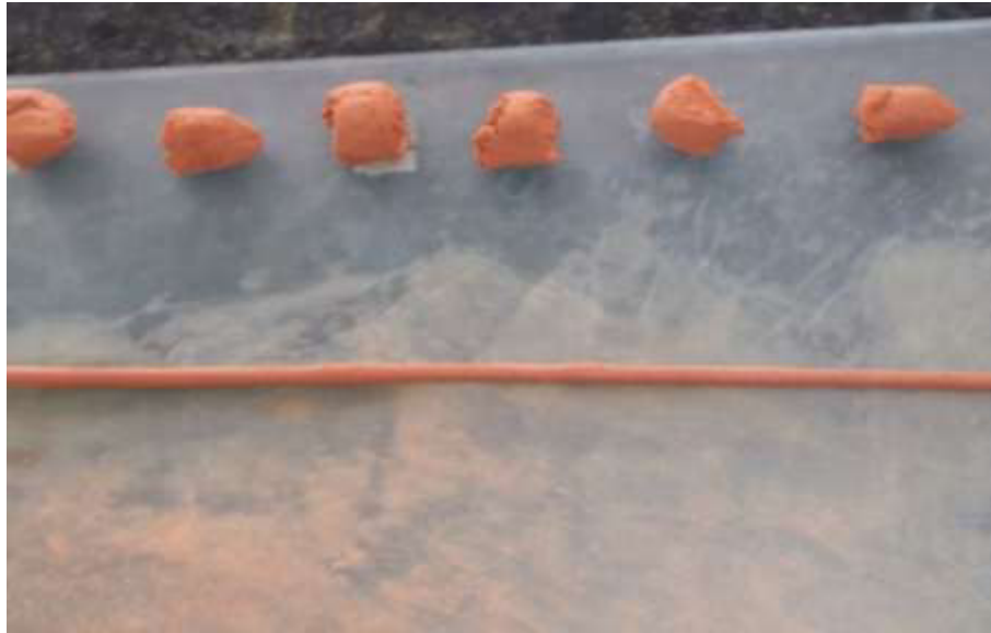
Figura 3: Ensaio de plasticidade.
