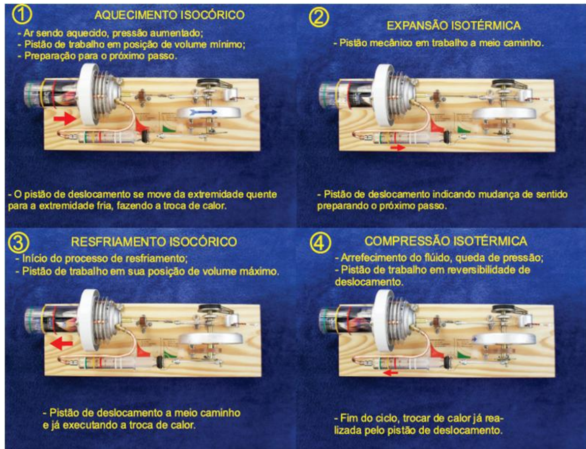
Figura 3: Os quatro tempos do motor de Stirling mostrando as respectivas posições de cada êmbolo em cada tempo. As duas isotermas do ciclo da máquina de Stirling não são ligadas por processos adiabáticos, como na máquina de Carnot, mas por processos isocóricos.
