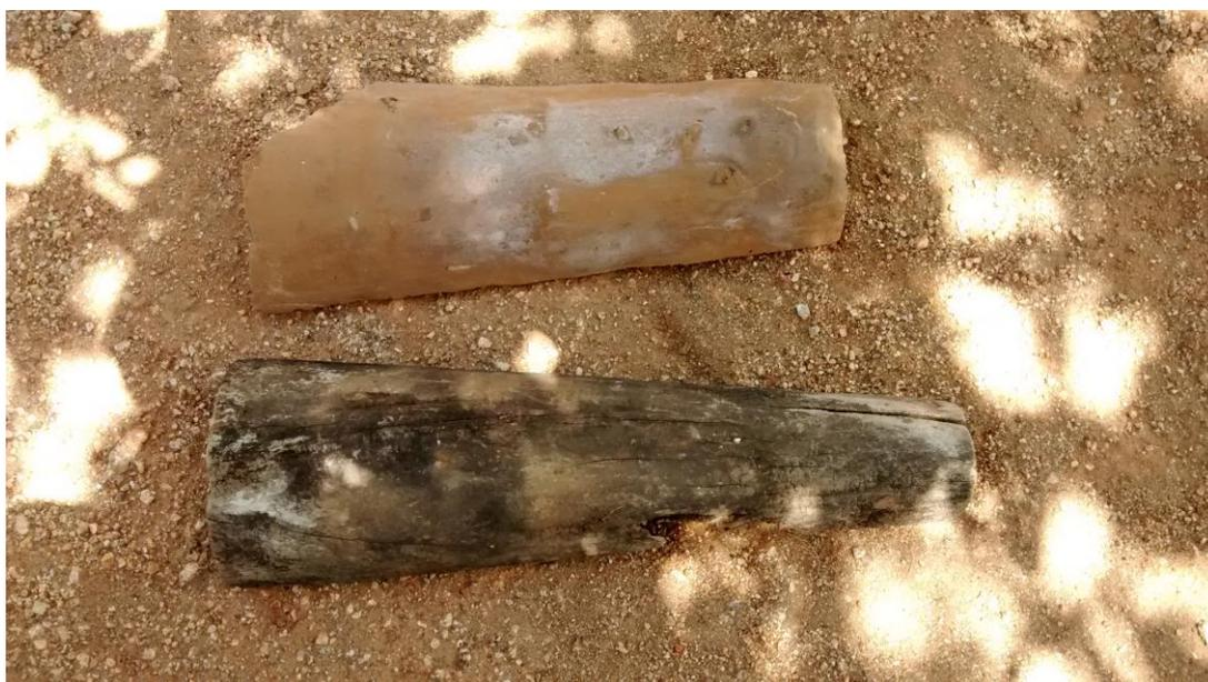
**Figura 5 - Telha feita pelos moradores de fôrma utilizada na sua fabricação. Fotos da autora (2014).**
