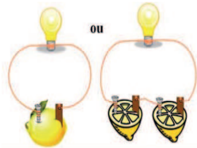
Figura13: Esquema da montagem da pilha de limão
