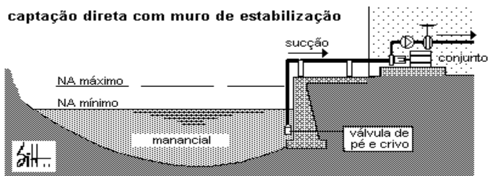
Figura 6: Captação de água bruta
