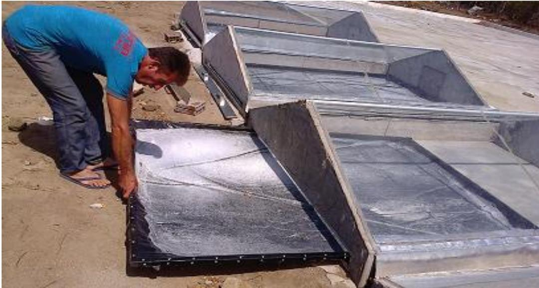
Figura 4: Retirada da lona Encerado para a limpeza dos sais acumulados após o processo de destilação das águas.
