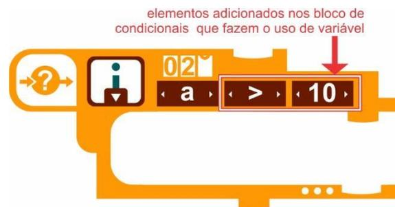
Figura 3 - Exemplo de bloco condicional com uso de variável
